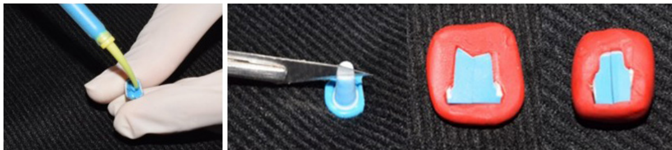
Figura 5. A) Colocación de silicona en la parte interna; y B) sección de la réplica de silicona.
