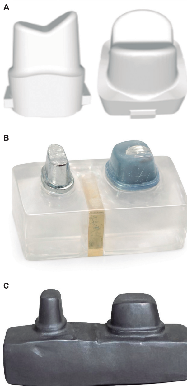
Figura 1. A) Diseño en software CAD; B) Modelo maestro en bloque de acrílico; C) Modelo maestro con base Co-Cr.
